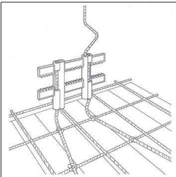
1. Die Optiflex-Rohrstütze 87069 mithilfe der Rohrbinder an der Schalung befestigen.
