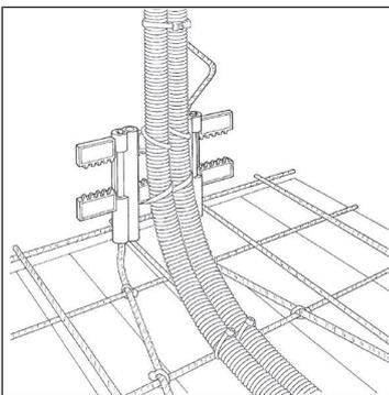
2. Die Optiflex-Rohre mithilfe der Rohrbinder an der Rohrstütze und an der Schalung befestigen.
