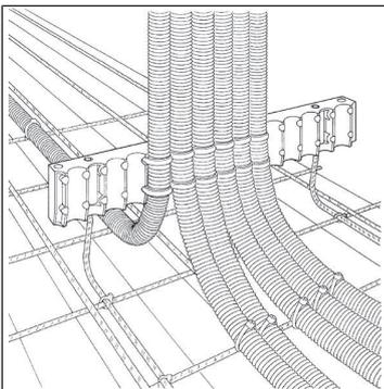
2. Die Optiflex-Rohre mithilfe der Rohrbinder an der Optiflex-Mehrfach-Rohrstütze und an der Schalung befestigen.
