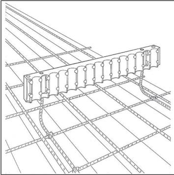
1. Die Optiflex-Mehrfach-Rohrstütze 87058 mithilfe der Rohrbinder an der Schalung befestigen.
