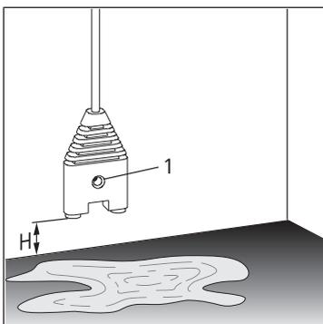
1. Die Montageposition an der Wand ermitteln und die Position der Schraube **(1)** anzeichnen. Idealerweise den Wasserfühler am tiefsten Punkt des Raumes montieren. Der Abstand der Kontakte zum Boden (**H**) entspricht der Wassertiefe, ab welcher der Wasserfühler aktiviert wird.
