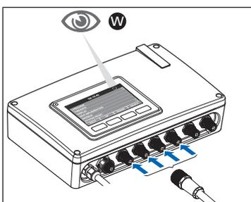
3. Das Kabel normgerecht verlegen und den Stecker am Controller anschliessen.
